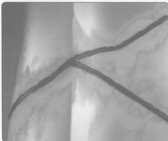
Сварной шов должен немного выступать и быть гладким.
