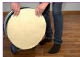
3 - Зафиксируйте пад на машине
