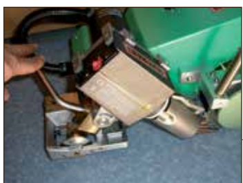
Поднять рукоятку и поместить наконечник напротив сварочного шва.
