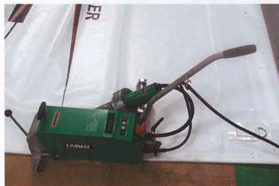
УНИМАТ при сварке кромки 40 мм на тентовой ткани. Скорость до 8.5 м/мин.
