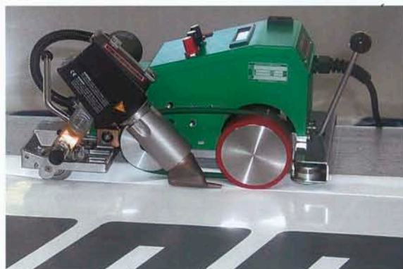
Сварка канта при помощи УНИПЛАН
