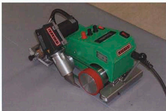
Сварка внахлест автомобильного тента. Скорость сварки – ок. 7 м/мин.
