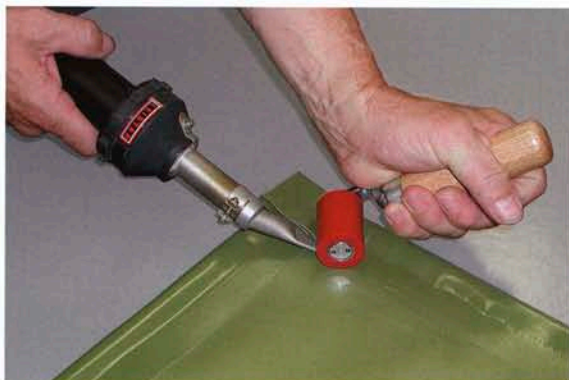
Хот-Джет S с щелевой насадкой и прикаточным роликом при сварке рекламного баннера.
