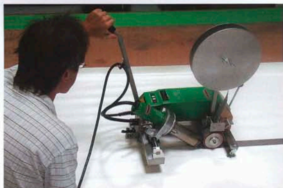
Наварка ленты 50 мм на автотент. УНИМАТ гарантирует высокую скорость сварки
