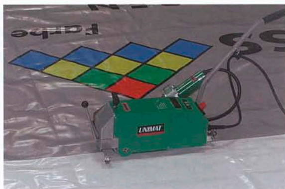
УНИМАТ при сварке внахлест шва 20 мм автомобильного тента. Скорость сварки до 12 м/мин.
