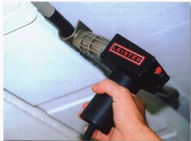
ГИБЛИ с решетчатой рефлекторной насадкой при усадке термоусадочной муфты из ПВХ.
