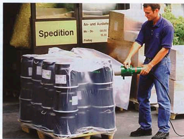
Усадка термоусадочной пленки на палетах перед транспортировкой аппаратом ФОРТЕ S3. Отсутствие открытого огня позволяет работать в небольших закрытых помещениях.
