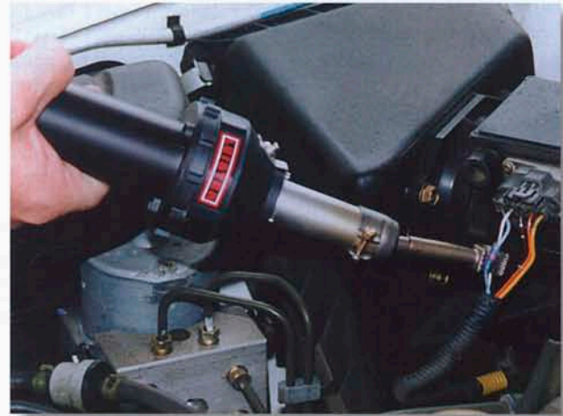
ХОТ-ДЖЕТ S с ложковой решетчатой насадкой при усадке муфты с припоем для спайки соединения.
