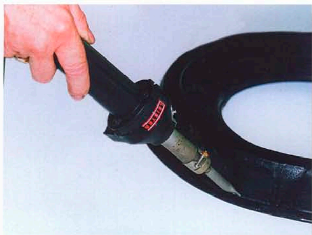
Аппарат ХОТ-ДЖЕТ S с насадкой для прихватки перед сваркой полиэтилена.
