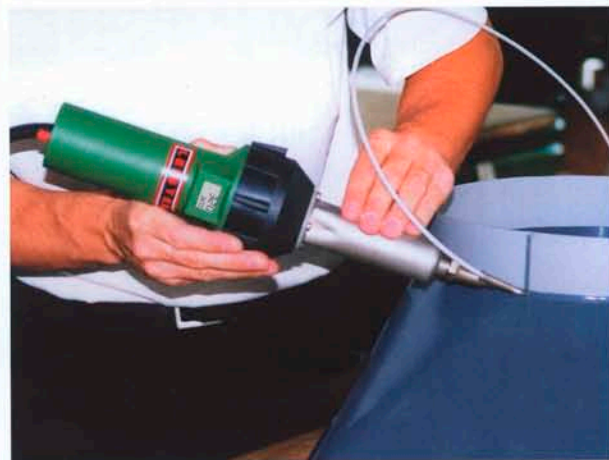
Аппарат ТРИАК PID с насадкой при наварке крышки из ПВХ
