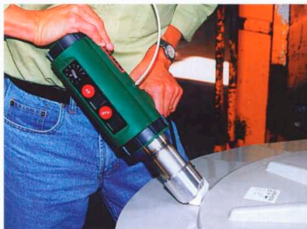
Сварка миниэкструдером Велдмакс при создании изделия из полипропилена
