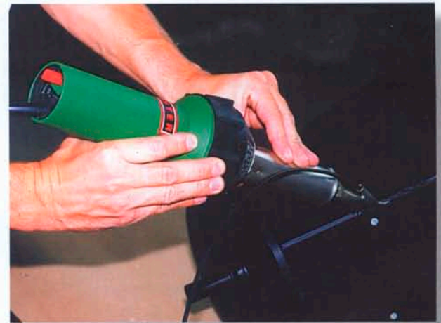
Аппарат ТРИАК S с насадкой при наварке крышки из ПВХ
