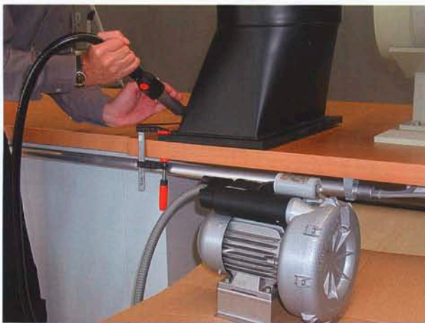
Велдинг PEN – самый маленький и удобный сварочный аппарат. Подача воздуха – от вентилятора Робуст.
