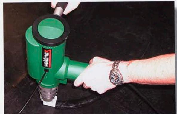
Сварка экструдером WELDMAX при ремонте геомембраны из ПЭ-НД
